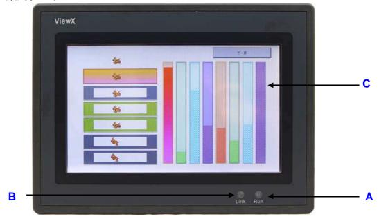
A RUN: 紅燈顯示 STOP 等待下載程式,綠燈閃爍顯示正常運作
