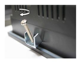
請將固定金屬扣環安裝在 VX 760T 側邊,金屬扣環勾住前蓋,螺絲頭頂住控制箱內側
